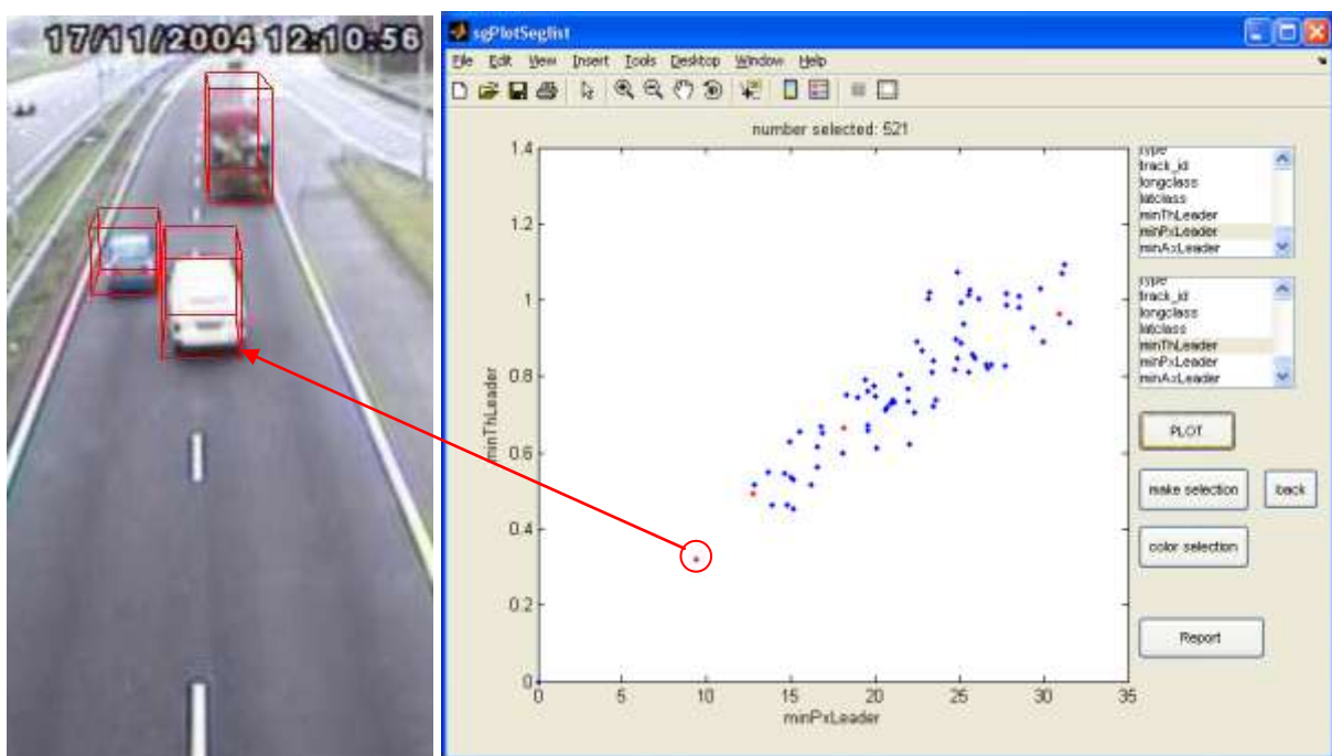
Figuur 2: Voorbeeld van een “bumperklever” bij rijstrookwisseling, met een minimale volgtijd van 0.3 sec (y-as in rechter figuur) en een longitudinale afstand tot de voorligger van 9.4 m (x-as). De rechter figuur toont de trajectoriën met een minimale volgtijd van minder dan 1 sec voor twee klassen van laterale bewegingen; naar links (rood), en rechtdoor (blauw).
