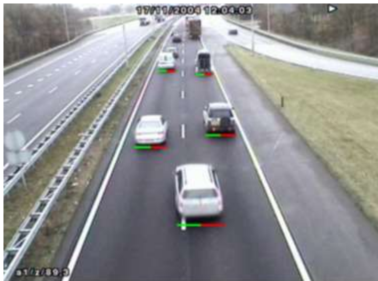
Figuur 1: Verbeterde voertuigdetectie ten opzicht van [1]. De groen-rode balk is de projectielijn van de achterkant van een voertuig op het wegdek.
